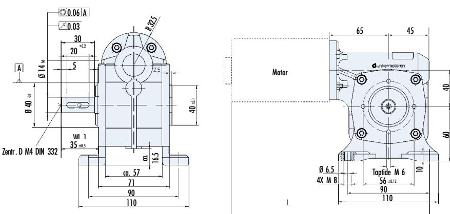
Dimensions in mm SG 120 B14/ Maßzeichnung in mm SG 120 B14
