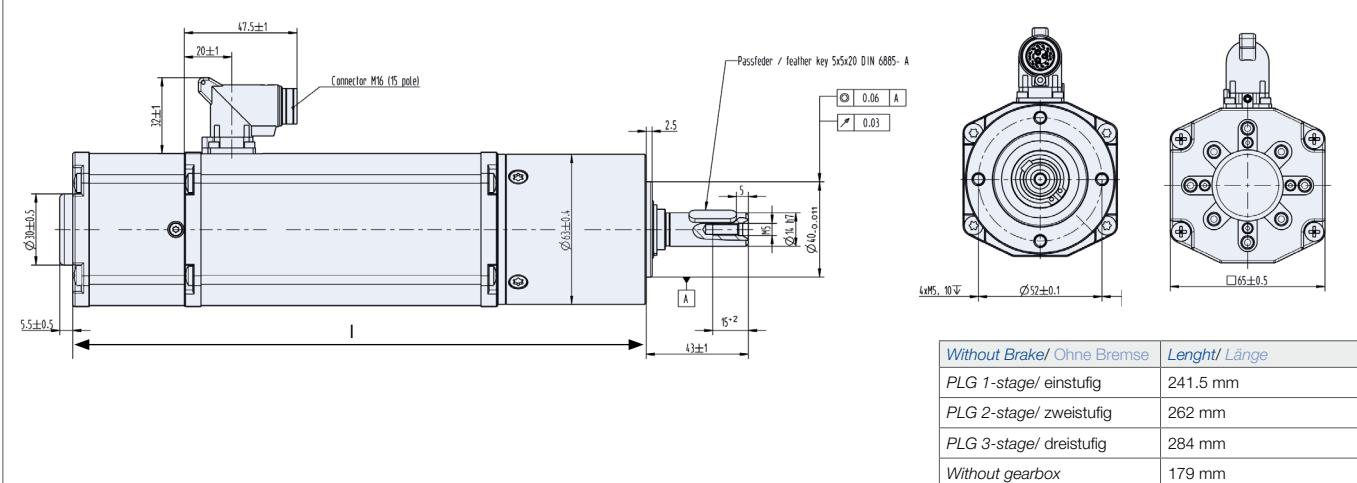
Dimensions in mm Motor with brake/ Maßzeichnung in mm Motor mit Bremse
