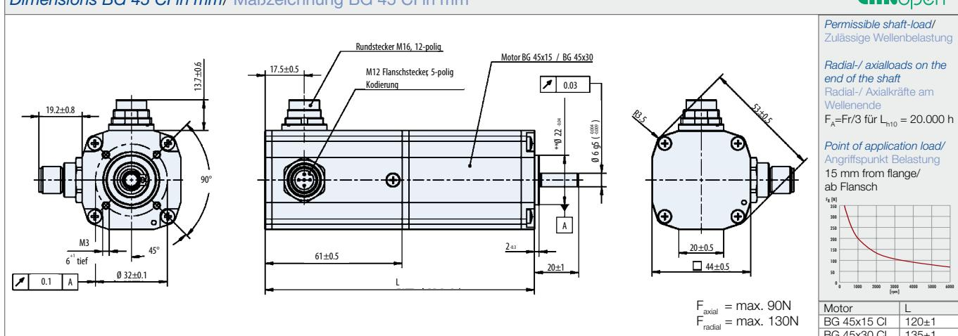
Dimensions BG 45 PB in mm/ Maßzeichnung BG 45 PB in mm
