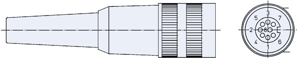
**3 Connector with cable for RE 20/ 30/ 56/ Stecker mit Kabel für RE 20/ 30/ 56**
