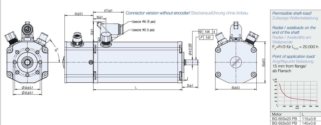
Dimensions BG 65S EC in mm/ Maßzeichnung BG 65S EC in mm
