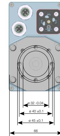
For detailed information on tolerances, please refer to the relevant motor dimensions./ Detaillierte Informationen zu Toleranzen entnehmen Sie bitte den entsprechenden Motorbezeichnungen.
