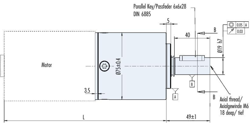
Bitte beachten Sie, dass die 2- und 3-stufigen Varianten mit 8 sturmseitigen Gewindebohrungen ausgeführt sind /
