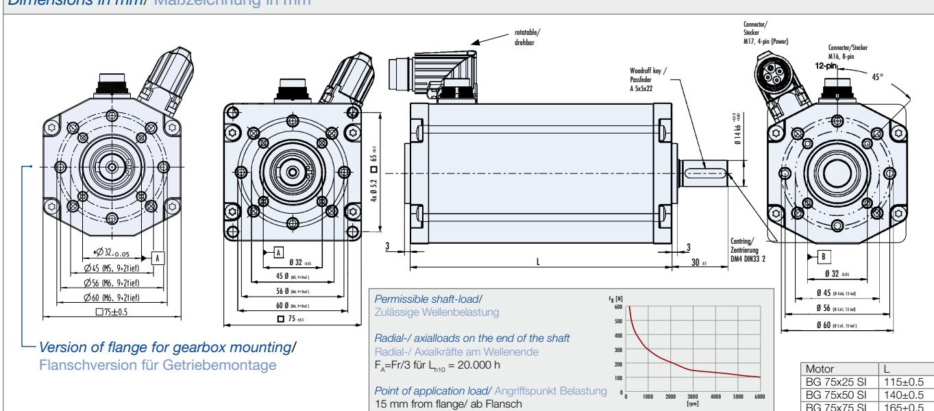
Characteristic diagram/ Belastungskennlinien
