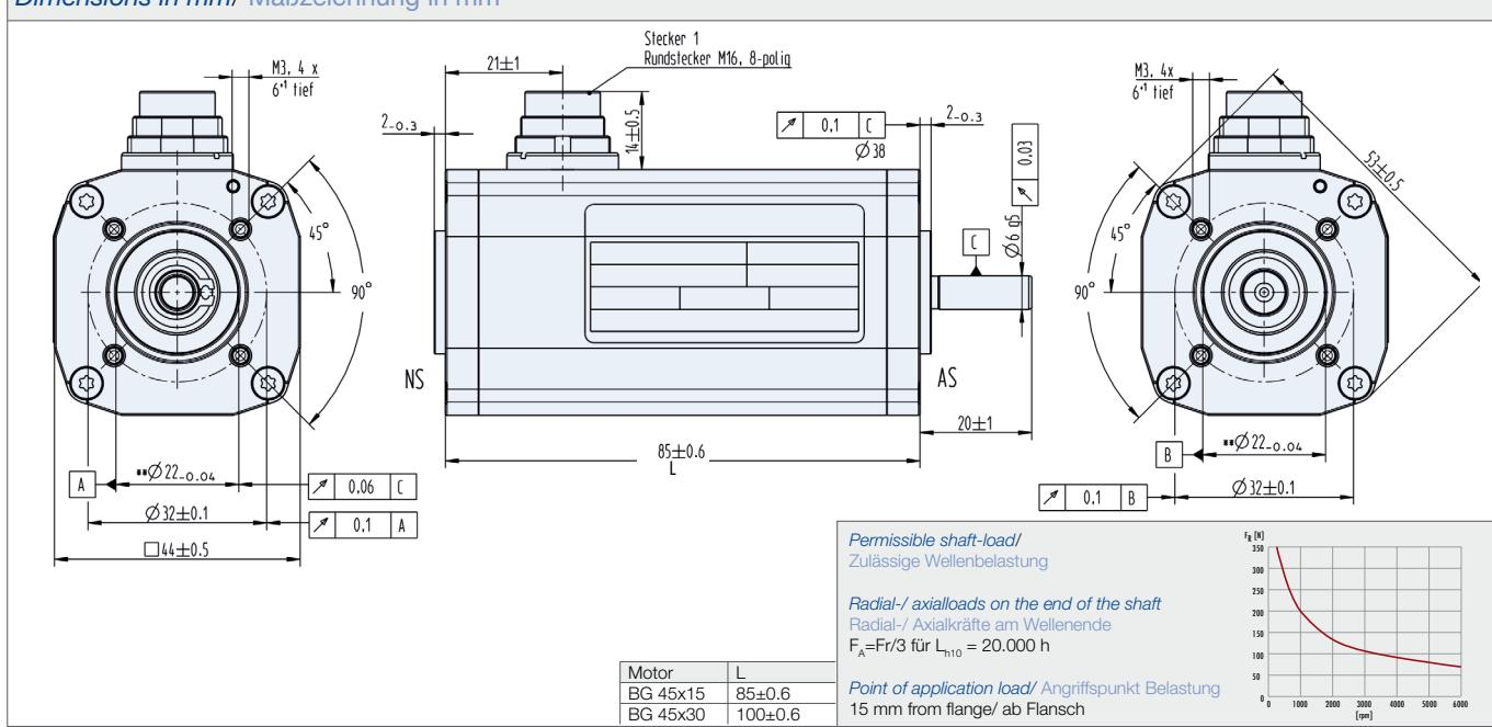
Characteristic diagram/ Belastungskennlinien
