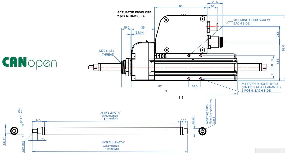
Thrust rod for SCA/ Magnetstange für SCA
